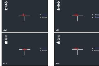
2. 选中图标 , 按键 切换选中调整X或者Y坐标值 (一个XY坐标值 = 1/4 mil), 按键 将十字分划线中心点调至与弹着点重合即完成校准 (最佳校准距离为25-50码/米);
