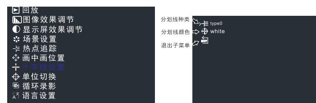
2. 按键(M)移动> 选中图标 ━ , 按键(④)(④)切换十字分划线类型, 选中后按键(④)确认;
